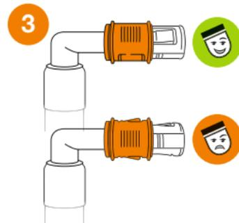
Stellen Sie sicher, dass der Sicherungsschieber am Schlauch nicht verdreht ist.
